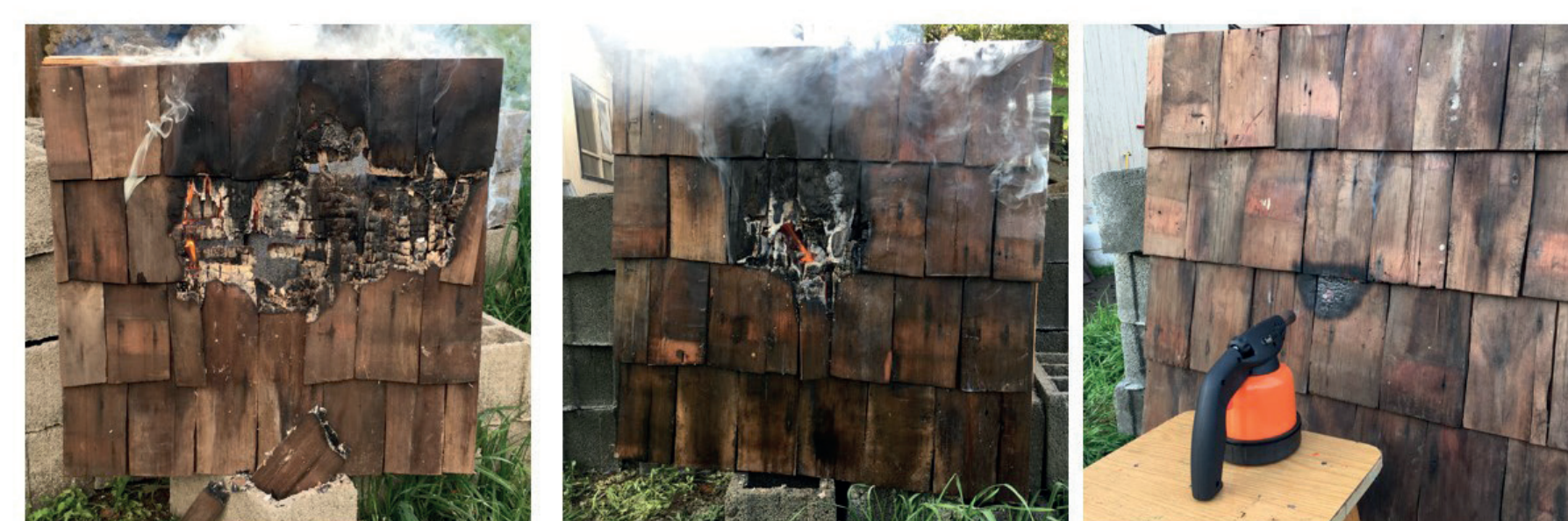
REVESTIMIENTO EXTERIOR SIN PRODUCTO IGNIFUGO 40 minutos con llama a 15 cms. REVESTIMIENTO EXTERIOR CON BARNIZ IGNIFUGO 40 minutos con llama a 15 cms. REVESTIMIENTO EXTERIOR CON SALES IGNIFUGAS 40 minutos con llama a 15 cms, se acerca soplete.
