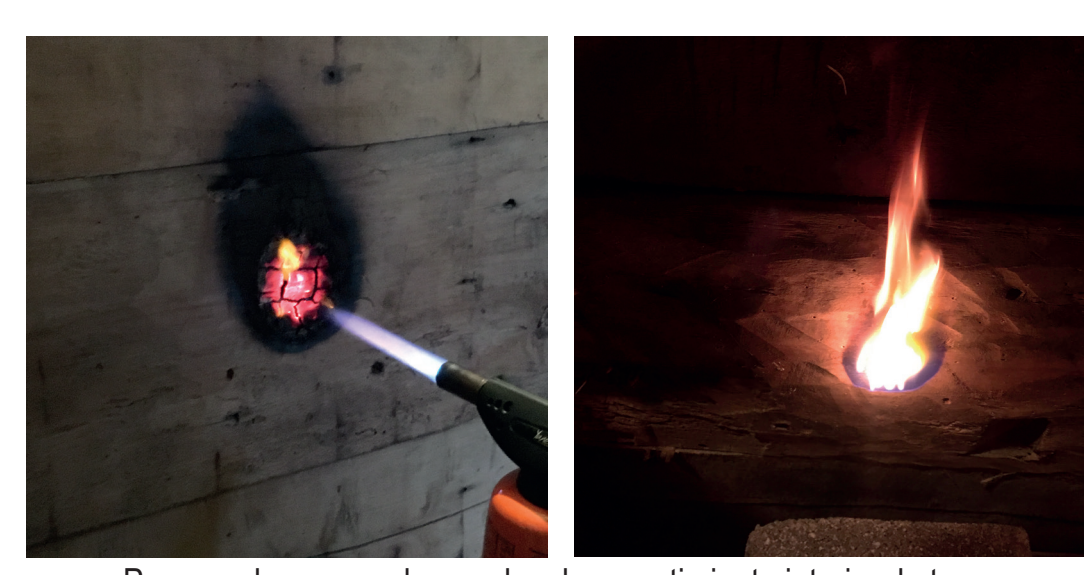
Proceso de ensayo de paneles de revestimiento interior de tepa. Fuente: Elaboración propia.
