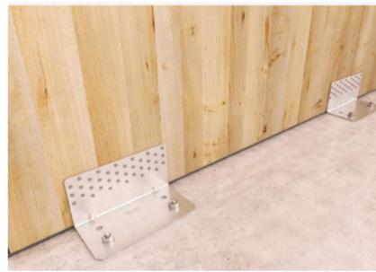
Mientras que para soportar la demanda de corte, es necesario la implementación de un total de 5 placas conectoras de corte, conectadas al panel con 36 elementos cilíndricos (diámetro nominal 4 mm).
