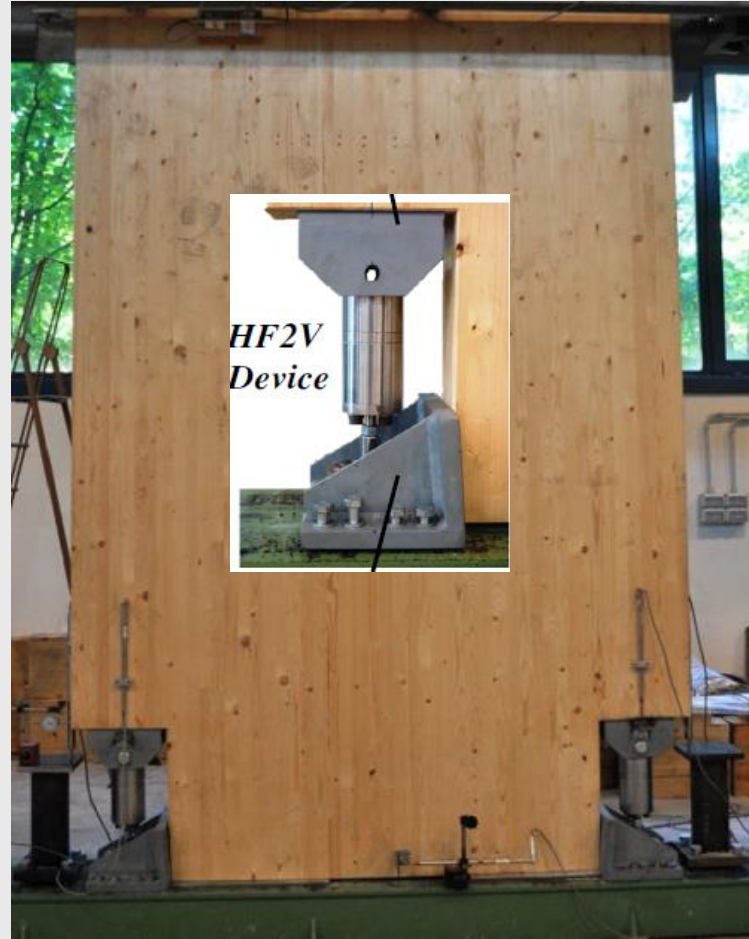
Figura 19: Disipador de histéresis Fuente: Wrzesniak et al. (2016)
