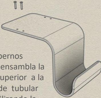
Se utilizan pernos coche para ensambla la superficie superior a la estructura de tubular de fierro utilizando la llave corona "11"
