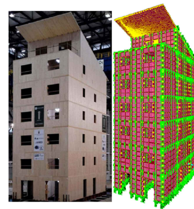
A la izquierda la estructura real y a la derecha modelo de elementos finitos
