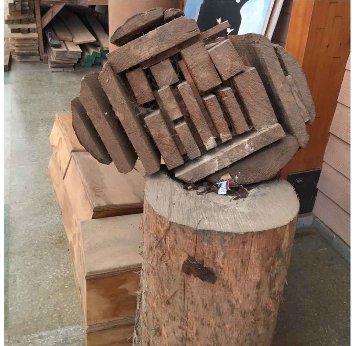
Cortes de un tronco para madera aserrada en Liceo Técnico Licantén. Fuente: SIERRA, A. Charla "El Ciclo de la Madera" Madera 21, 2018.
