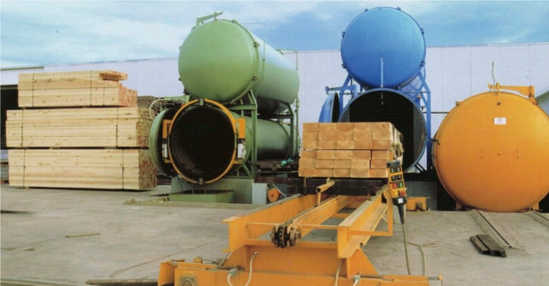
Proceso de Impregnación de la Madera. Fuente: MACHINIO
