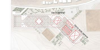
Los vacios iluminan el primer piso, y dan la posibilidad a los pilares de llegar directamente hacia la cubierta.
