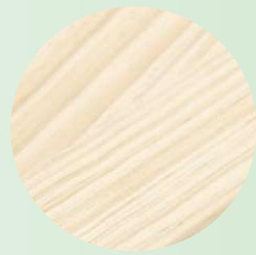
Doble capa de terciado de Pino de 15 mm, cortado en CNC Router y con acabado de barniz natural.
