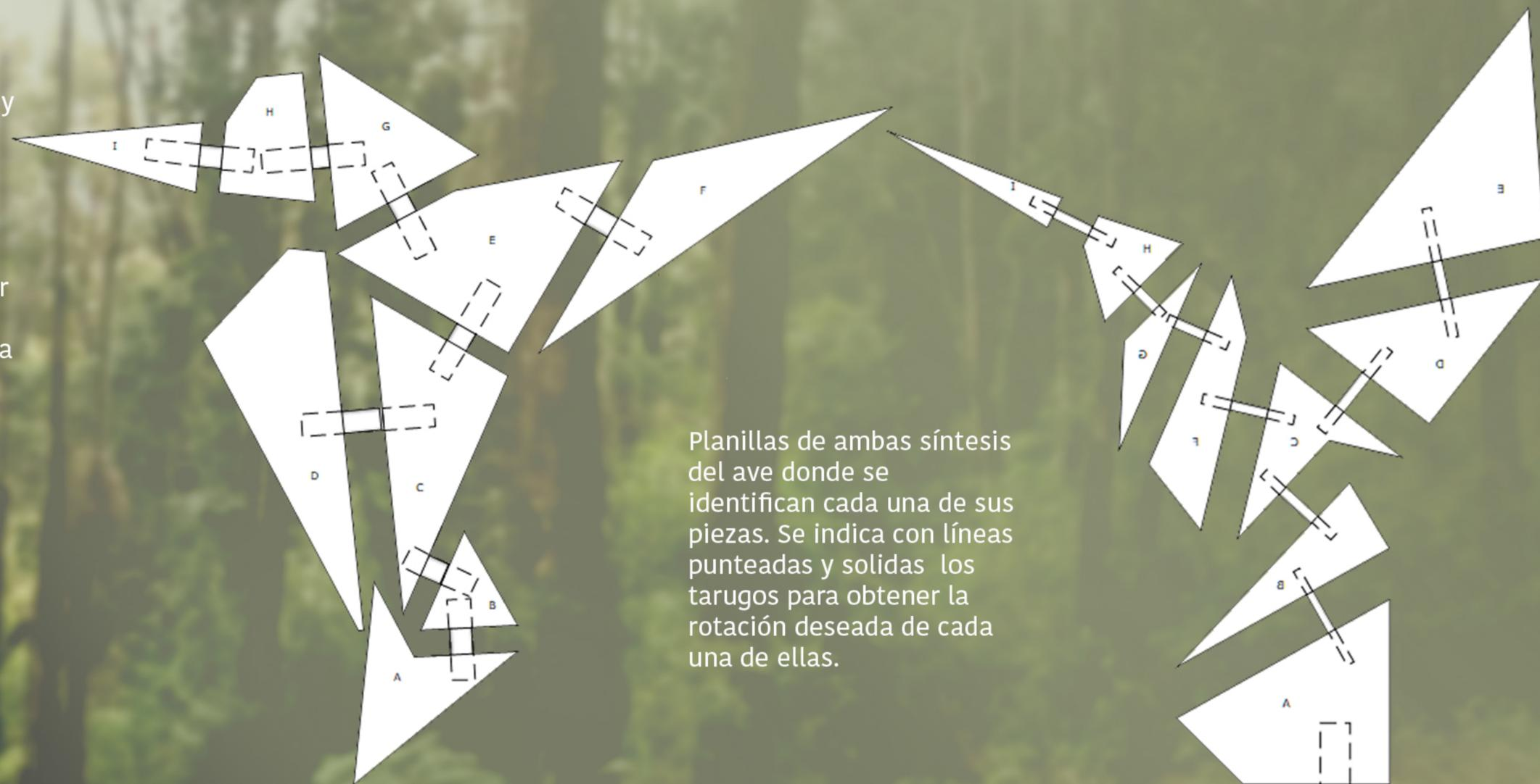
Planillas de ambas síntesis del ave donde se identifican cada una de sus piezas. Se indica con líneas punteadas y solidas los tarugos para obtener la rotación deseada de cada una de ellas.
