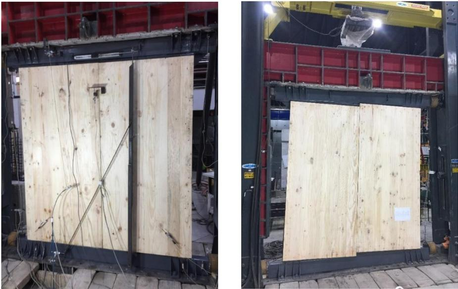
Figura. Ilustración del muro FPSW (a) instrumentación del muro (b) el ciclo final del ensayo cíclico en el marco rígido JIKA.
