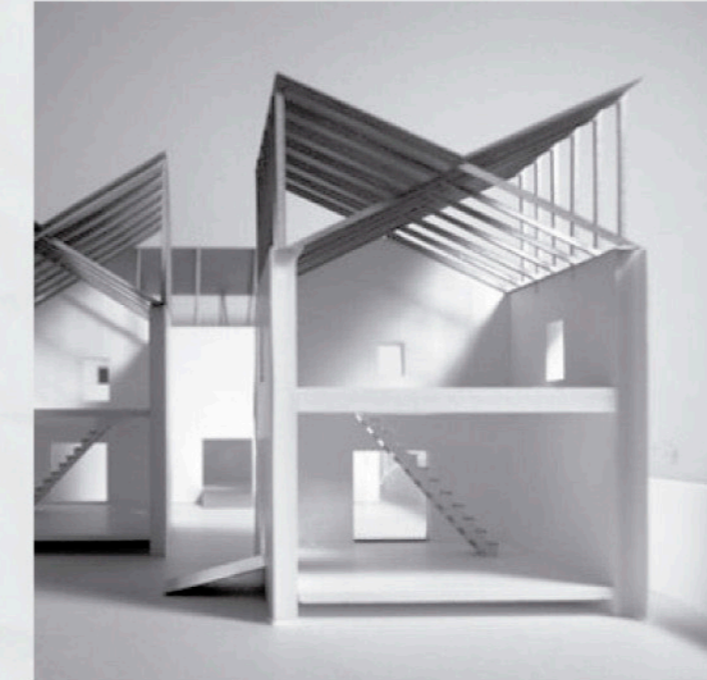
"Alumi roof for light" de Shuichiro Yoshida para el concurso SUS ALUMINIUM COMPETITION, utilizó cubiertas tipo mariposa que resultan en lucarnas que permiten el ingreso de luz a los espacios menos transparentes, que serían los tres ejes de volúmenes principales.
