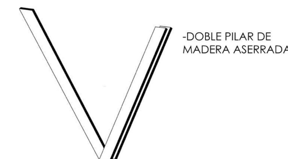
- PILARES DE MADERA ANCLADOS A MURO EXTERIOR - 2X10"
