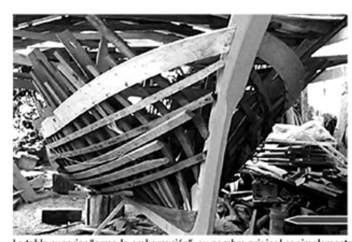
La tabla superior "como la embarcación", su nombre original es simplemente la "tabla armadora". (Hernández, Jaime. Carpintería de Ribera Río Cutipay, Julio 2014)
