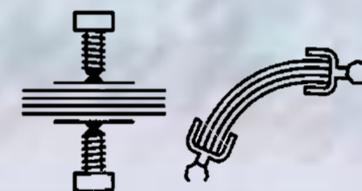
Los laminados de pino radiata serán logrados mediante moldes de terciado.
