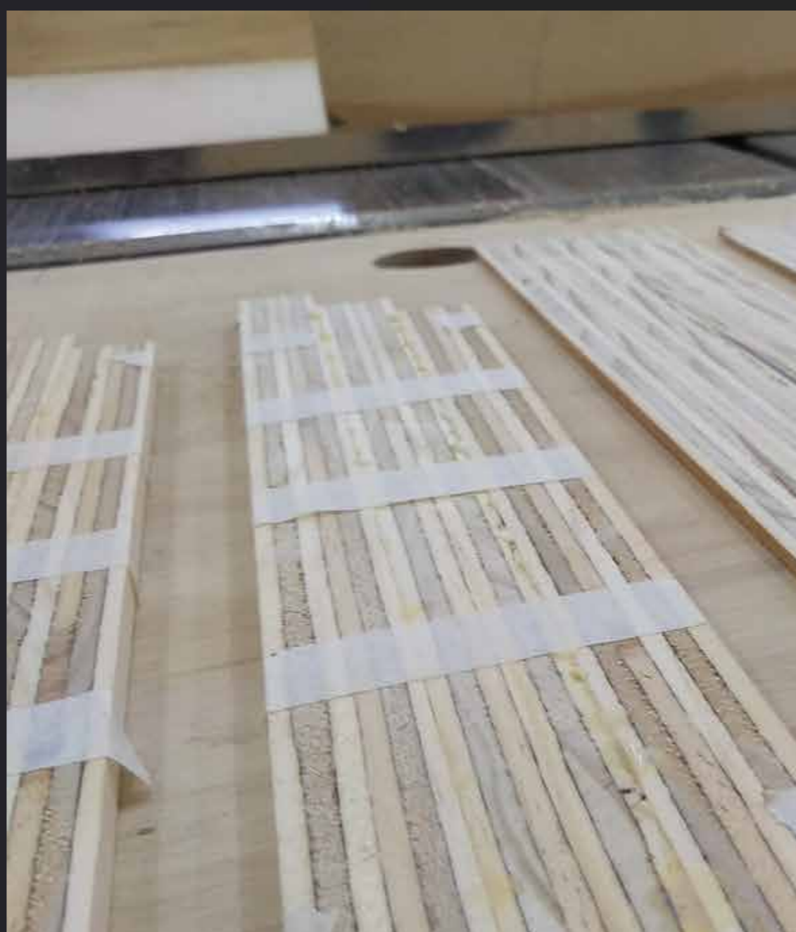
Pegado de varillas de terciado
