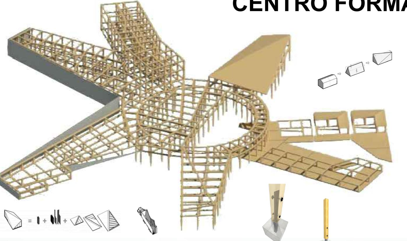
El proyecto tiene un sistema de estructura modular en el edificio residencial y palafitos, mientras que presiste la madera laminal en el nucleo central y enterrado.
