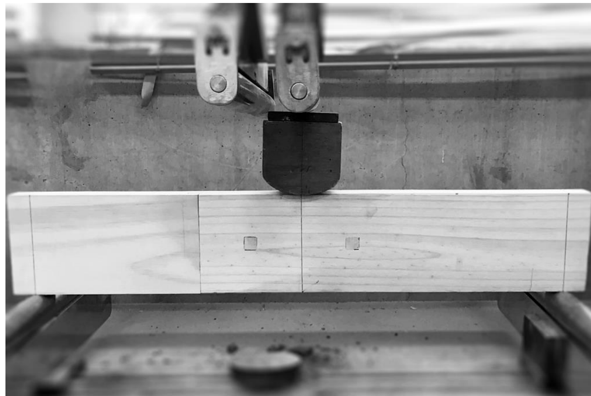
Imagen 29: Fotografía del ensayo de flexión a empalme oblicuo alojado vertical (elaboración propia)
