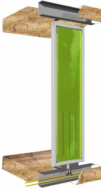
Cada panel contiene fluido entre dos vidrios colocados en una estructura de aluminio; un conducto de entrada y otro de salida garantizan el continuo flujo de unos a otros, impulsado por aire comprimido. Así se consigue que no se pudran. Además, se inyecta en el sistema dióxido de carbono de forma homogénea, que ayuda en el crecimiento de las algas
