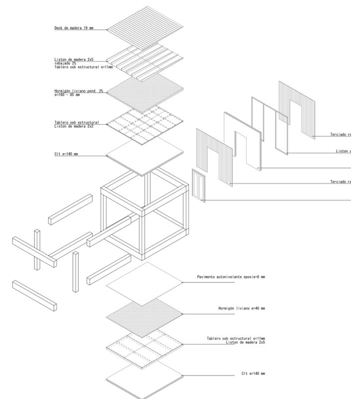
La madera como elemento de construcción de posible modulación y prefabricación. El módulo como elemento arquitectónico que se repite y crece, posándose en su contexto en forma escalonada conformando la forma total. Usando pilares y vigas de madera laminada para generar los marcos de los módulos arriostrados por planos verticales y horizontales de madera de CLT, intercandose con paños vidriados para facilitar las vistas hacia el horizonte.
