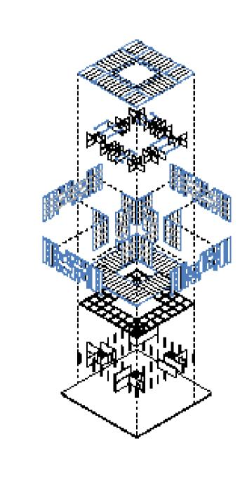
El primer nivel del edificio está fabricado con hormigón armado, material que brinda un soporte que se adapta a cualquier tipo de terreno y superficie. La versatilidad constructiva también se debe al uso de piezas prefabricadas que minimizan tiempos y costos de construcción.
