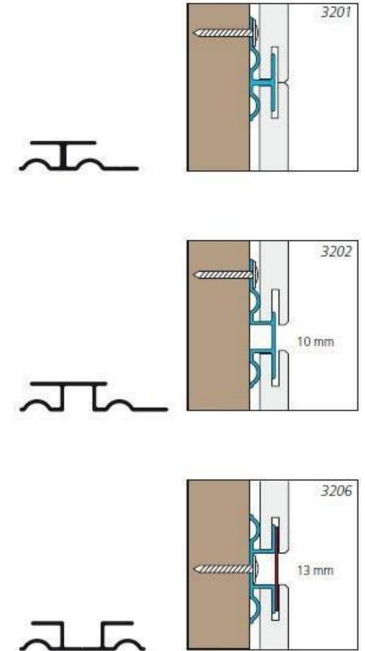
La fijación del revestimiento a un muro, se plantea por medio de un perfil secundario, el cual se debe fijar al muro a través de tornillos de manera preliminar, conservando las distancias y niveles necesarios. Posterior a eso por medio de un sistema click, el revestimiento se fija al perfil.
