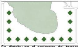
Se distribuyen al perimetro del terreno bloques de hormigon de caracter publico que permiten ser la base del edificio y abrir la laguna entre las luces que quedan, estos se colocan a 45 grados para mejorar la luminosidad y la visual hacia el interior
