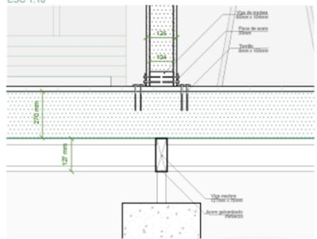
Detalle 2 / L2 - Unión pilar y techo diagonal
