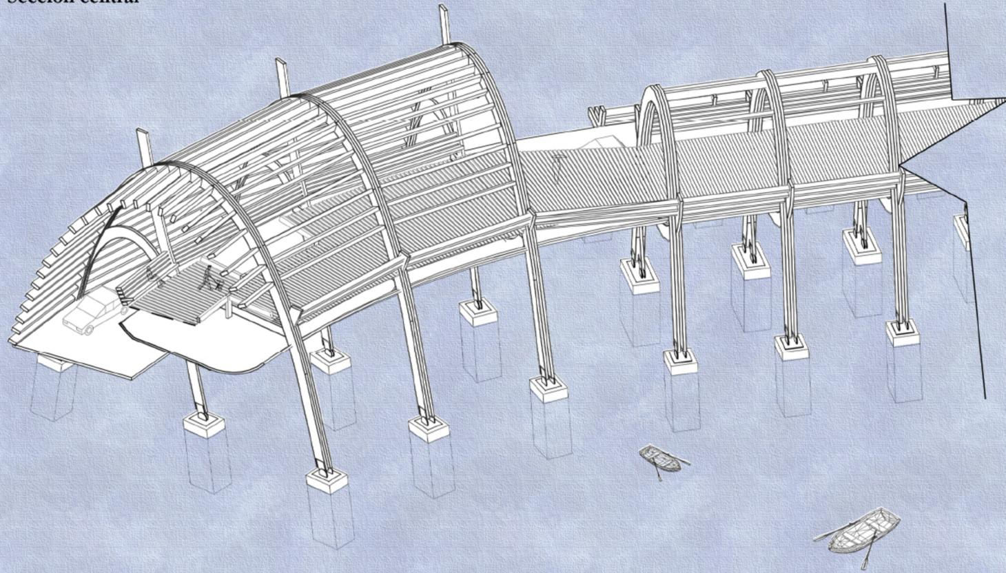
La catenaria que contiene el acueducto alcanza su amplitud máxima en la zona central del puente, incrementando la superficie usada para recolectar agua lluvia
