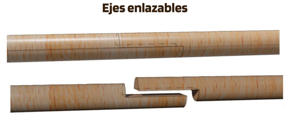
Permite conectar los paneles que se encuentren en un mismo eje, al girar uno, se giran todos los ejes conectados.
