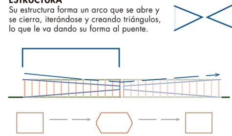
AXONOMÉTRICA EXPLOTADA DE LA ESTRUCTURA
