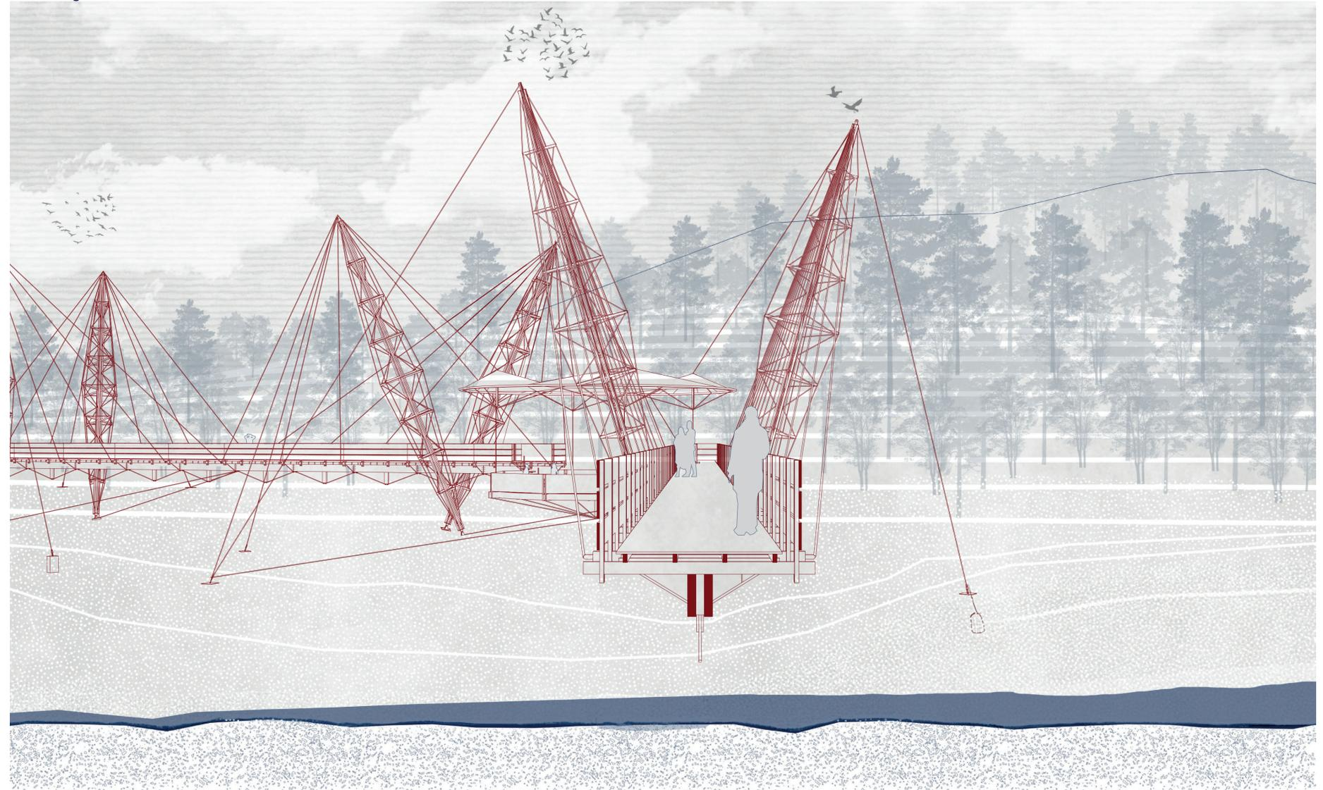
La viga del puente atriantado, segmentada en módulos de 5 metros y asegurada a cada pilar mediante un tensor, se ubica a 4 metros del humedal, alejándose del entorno natural. Esta configuración facilita la distribución de cargas y contrarresta a una estructura robusta y ligera, manteniendo una integración armónica y sostenible con el entorno.
