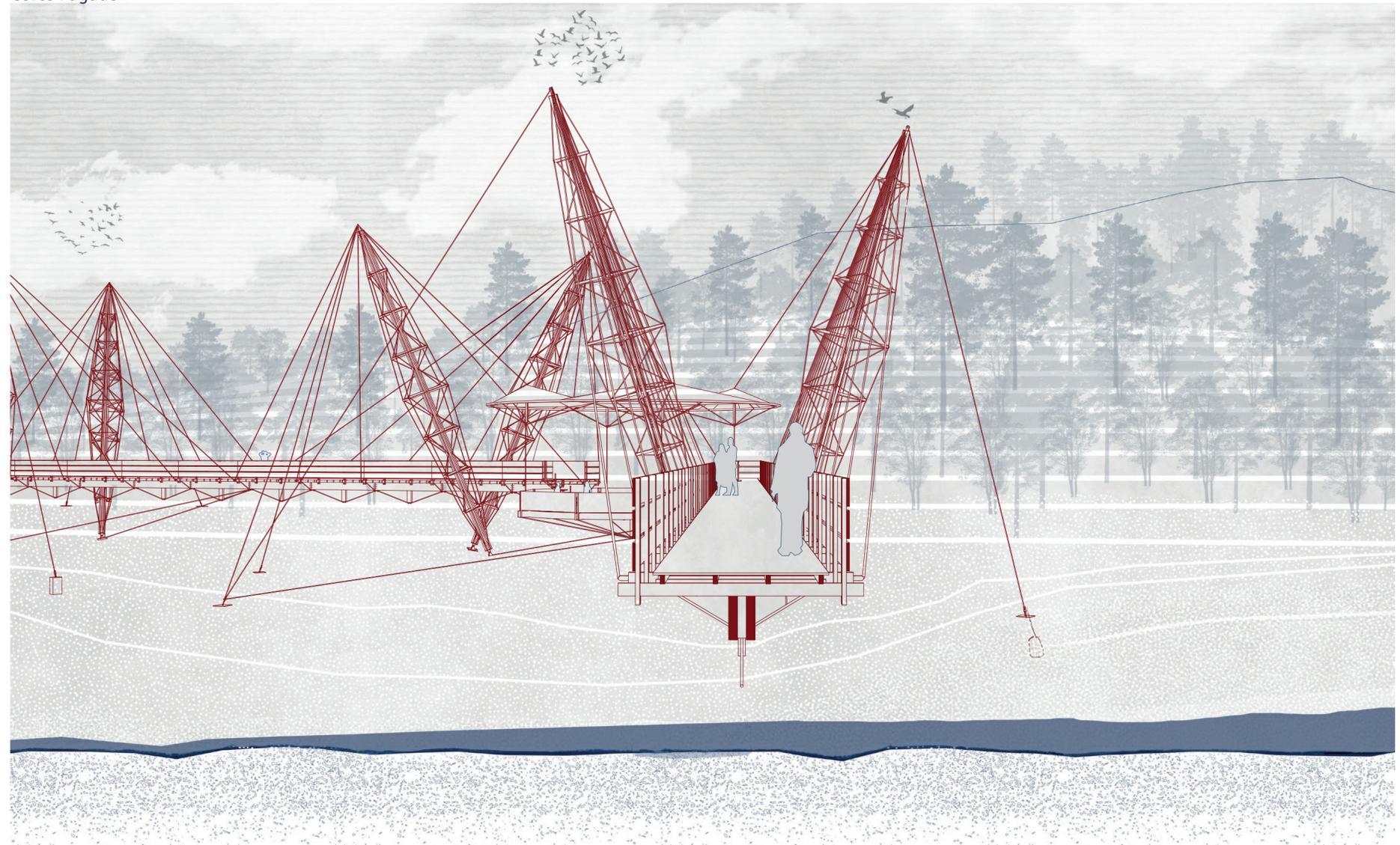
La viga del puente atirantado, segmentada en módulos de 5 metros y asegurada a cada pilar mediante un tensor, se ubica a 4 metros del humedal, alejándose del entorno natural. Esta configuración facilita la distribución de cargas y contribuye a una estructura robusta y ligera, manteniendo una integración armónica y sostenible con el entorno.
