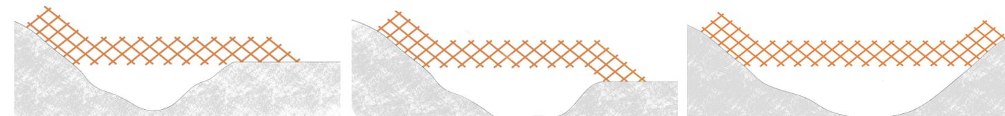
A: PUENTE QUE SE ADAPTA A QUEBRADA CON DISTINTOS NIVELES. B: PUENTE QUE SE ADAPTA A QUEBRADA A UN BAJO NIVEL. C: PUENTE QUE SE ADAPTA A QUEBRADA MÁS AMPLIA Y DE UN MISMO NIVEL.
