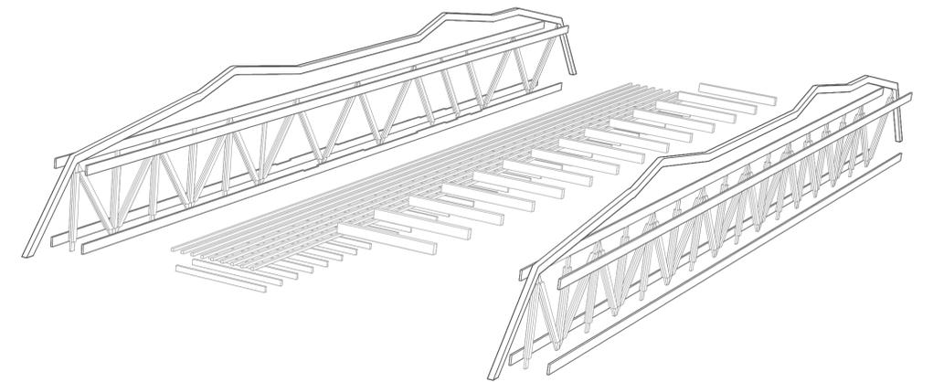
La estructura esta formada por dos grandes cerchas a cada lado de los puentes esta esta formada por cuatro vigas grandes dos en la parte superior y dos en la parte inferior y la forma de unir las es mediante las diagonales y verticales quedando estas al medio de cada viga ocultando así las uniones.
