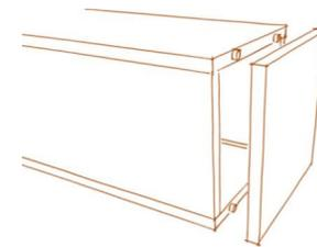
Unión mediante tarugos de madera
