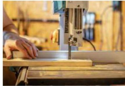
Utilizamos una sierra de huincha para cortar las piezas de madera con precisión. Esta herramienta nos permitió crear las estructuras de la lámpara de manera eficiente y exacta.
