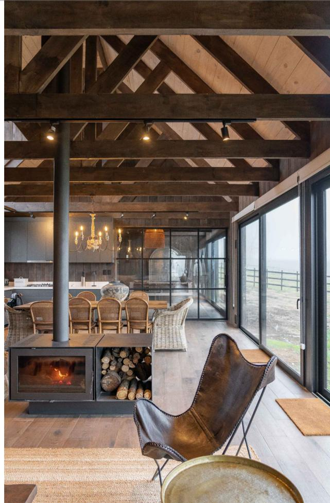
La principal innovación en el uso de madera en Casa Botafogo es que este material conforma la estructura, revestimientos interiores y exteriores, incluyendo la cubierta. Lo que genera un volúmen homogéneo por no existir aleros que rompan su geometría, sólo viéndose interrumpido este galpón habitable por vanos verticales de la altura de la cumbre. Estos grandes vanos permiten tanto la entrada de luz durante el día como vistas enmarcadas a la naturaleza.
