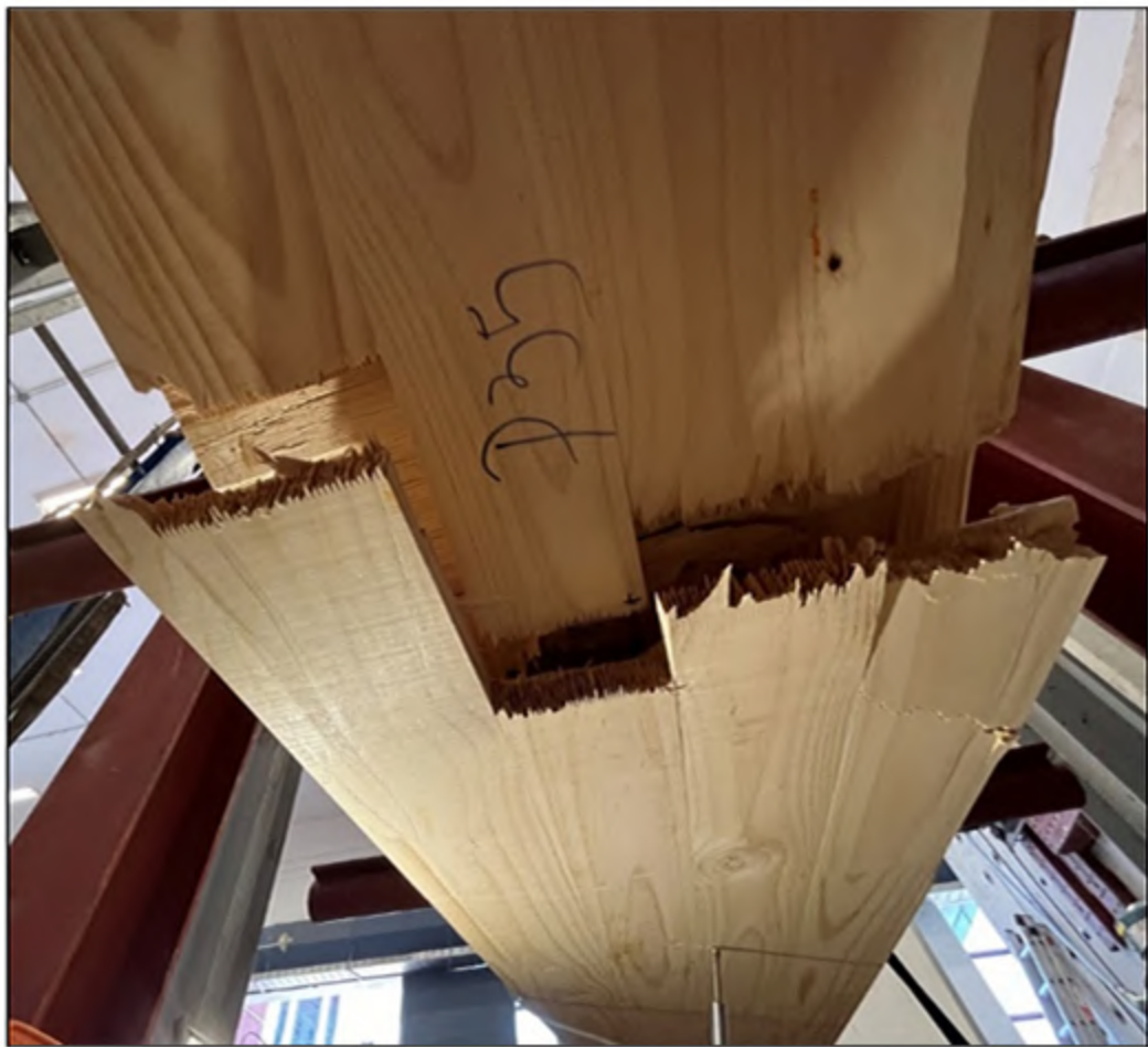
Figura 11 – Vista de la cara inferior de la falla a flexotensión en CLT 5 capas.
