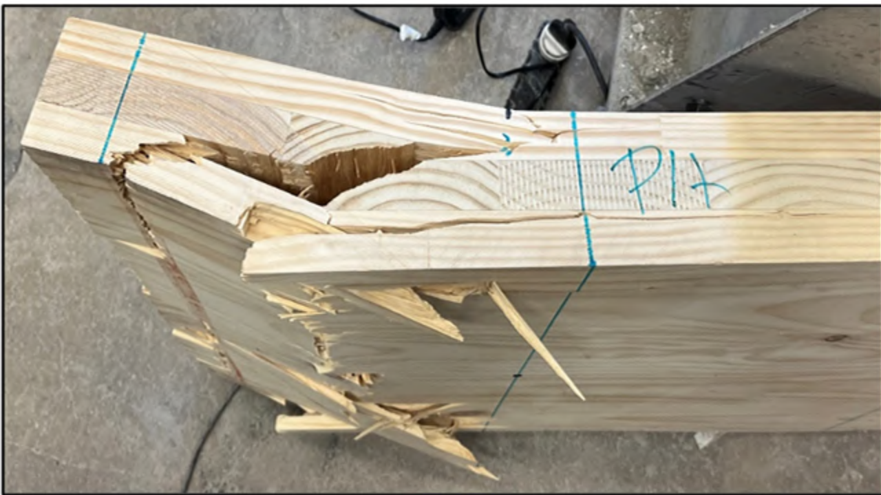
Figura 12 - Vista lateral de falla a cizalle rodante en CLT de 3 capas.
