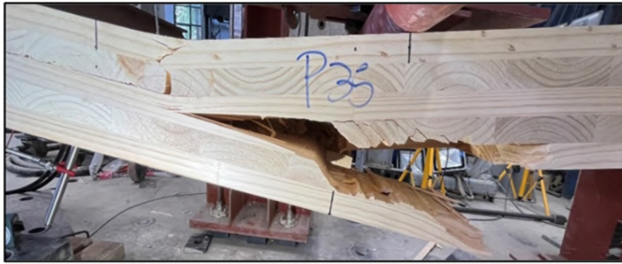
Figura 10 – Vista lateral de falla a flexotensión en CLT de 5 capas.
