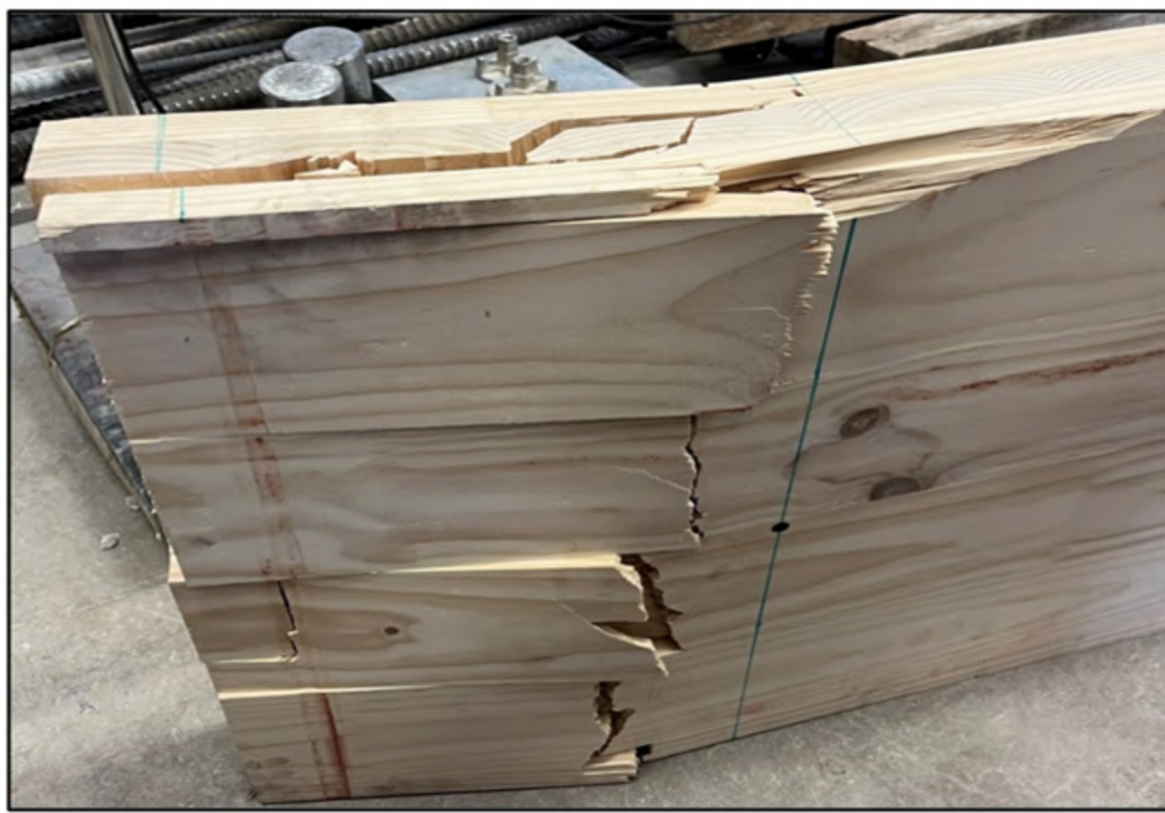
Figura 13 – Vista de la cara inferior de la falla a cizalle rodante en CLT 3 capas.
