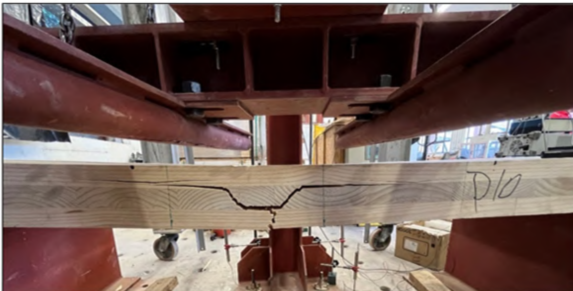
Figura 9 – Vista lateral de falla a flexotensión en CLT de 3 capas.
