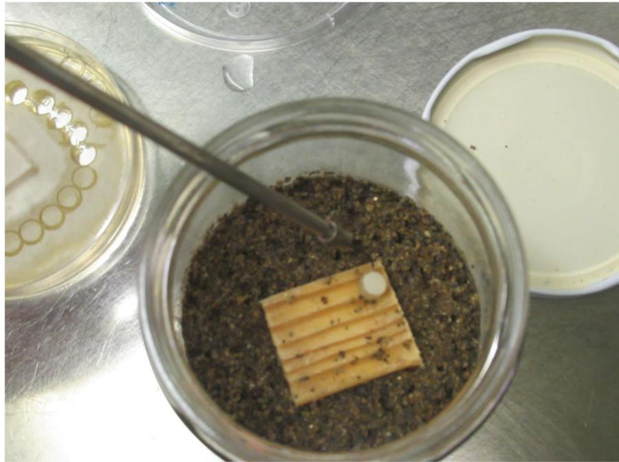
**Inoculación de una sección circular del hongo de pudrición sobre el sustrato alimenticio.**
