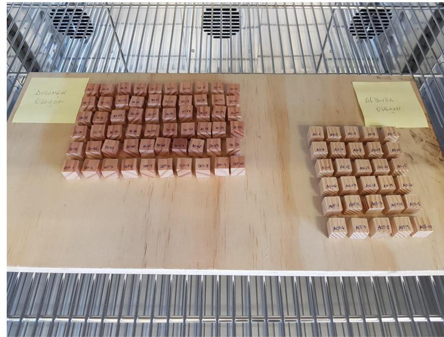
**Acondicionado de las probetas hasta lograr el 12% de C.H.**
