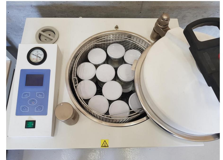
**Esterilización de las probetas, previamente acondicionadas, y de los frascos de vidrio con arena al 130% y sustrato alimenticio.**
