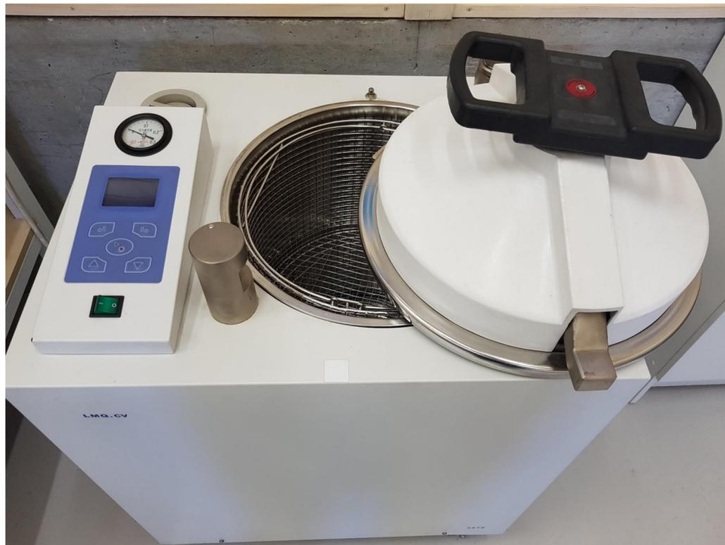
Autoclave para la esterilización de las probetas, arena y frascos de vidrio.
