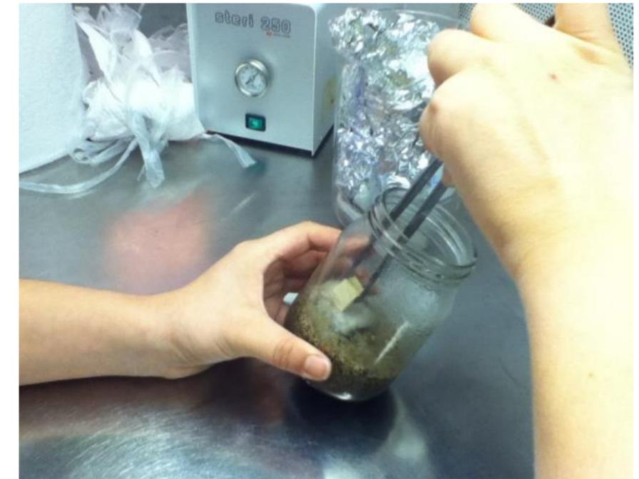
**Instalación de la probeta esterilizada sobre el sustrato alimenticio cubierto por micelio.**
