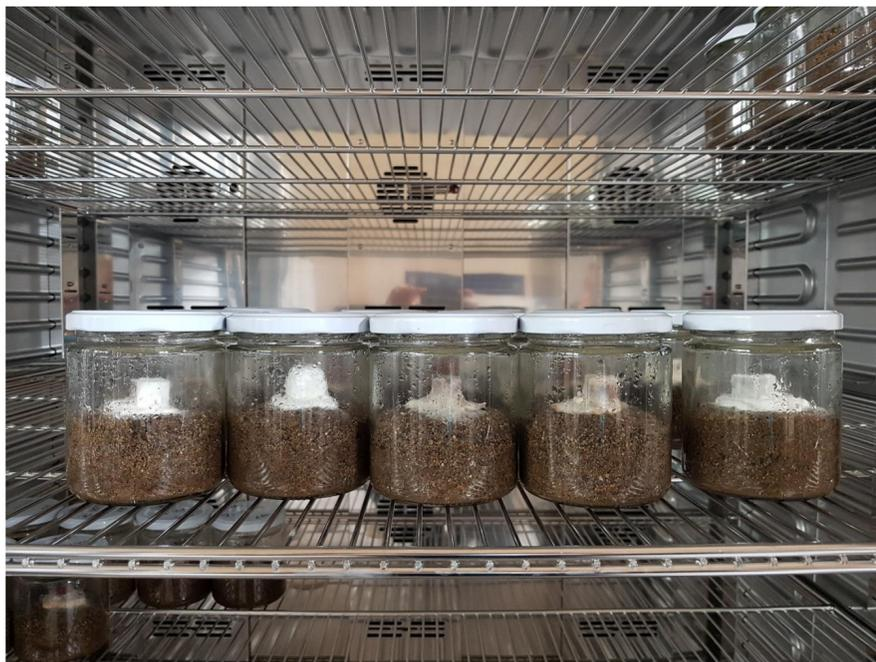
Exposición de las probetas a los hongos de pudrición en cámara climática a 25°C y 85% H.R.
