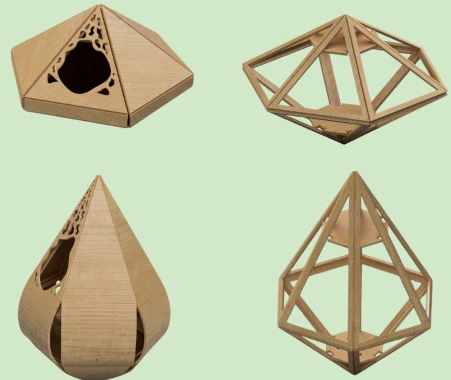
Se utilizó kerf para flexionar la madera y un esqueleto formado de triángulos para dar soporte a la pajarera. Para el corte de piezas se usó CNC láser.
