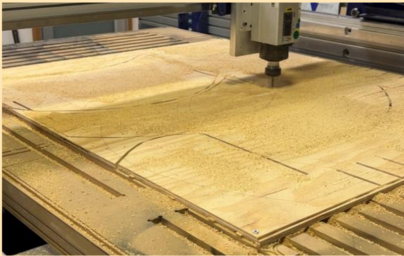
CNC router para cortar las piezas estructurales
