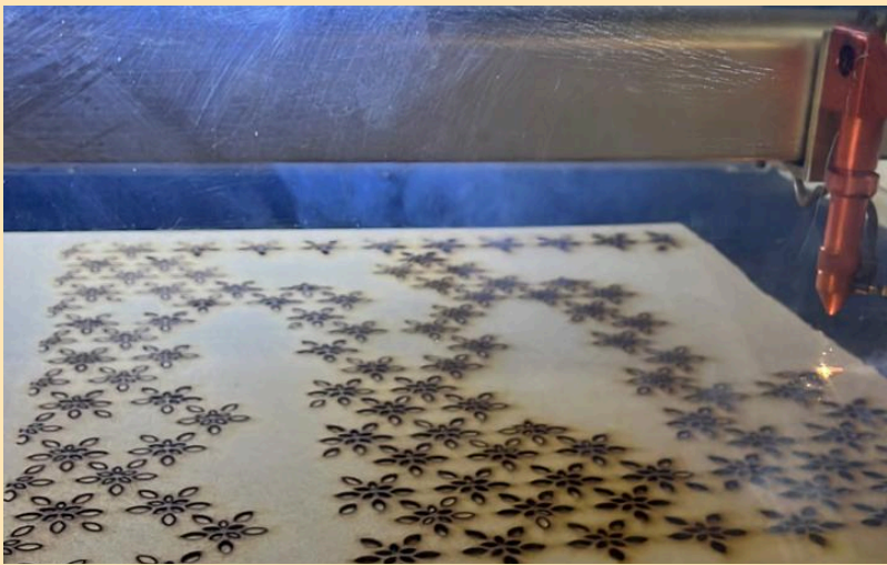
Corte láser para el tragaluz con patrón floral
